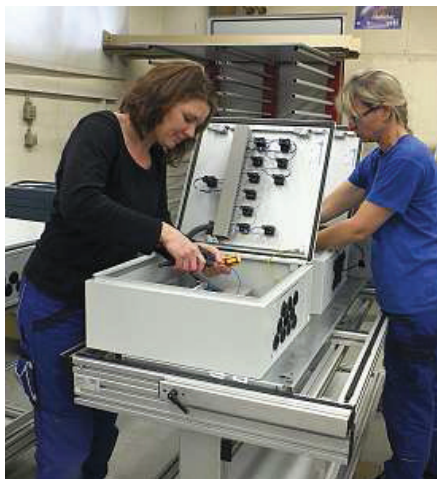
Annett Enke (links) und Katja Egelkraut verdrahten in der Salo-Fertigungshalle Schaltkästen für einen Großauftrag.
