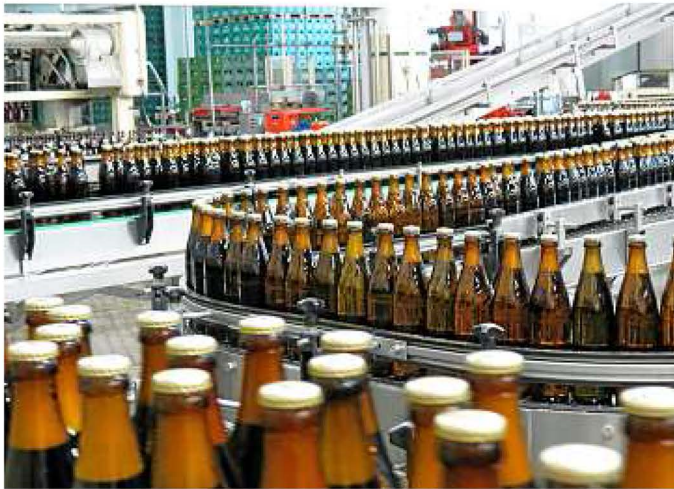
In der Vereinsbrauerei Greiz können dank einer modernen Füllanlage in der Stunde zwischen 25000 und 27000 Flaschen Bier abgefüllt werden. Fotos (2): Christine Schimmel
